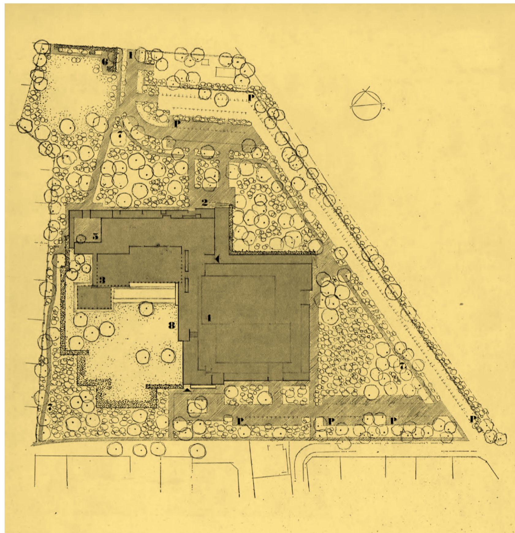
Agnete Muusfeldt, Kildeskovshallen, Gentofte. Arkivtegning Landskab 8, 1971. 1: indkørsel, 2: forplads, 3: svømmehaller, 4: idrætshaller, 5: servicegård, 6: læplads med sandkasse og bænke, 7: skovstier, 8: solplæne, P: parkering. Agnete Muusfeldt, Kildeskovshallen, Gentofte. Archive drawing, Landskab , 8, 1971.
